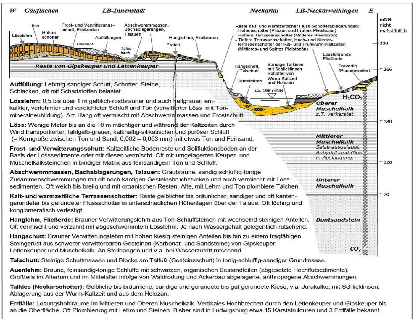
**Abb. 6: Profilschnitt der quartären Deckschichten auf den Gäuflächen, in Hangbereichen und im Neckartal (schematisch und überhöht)**
