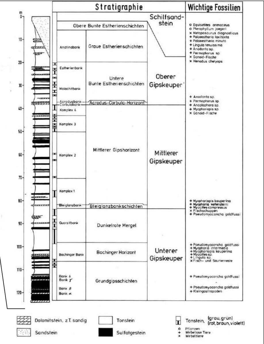
**Beilage 5d: Geologisches Standardprofil des Gipskeupers (Grabfeld-Formation) - Mittlerer Keuper - im Raum Stuttgart**
