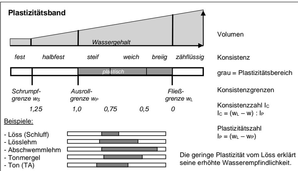
Der Bereich zwischen der Fließgrenze und der Ausrollgrenze wird Plastizitätsbereich (Bildsamkeitsbereich) genannt. Die Plastizität einer Bodenprobe kann im Plastizitätsband und im Plastizitätsdiagramm dargestellt werden. Je schmaler das Plastizitätsband, desto höher ist die Wasserempfindlichkeit der Probe.
