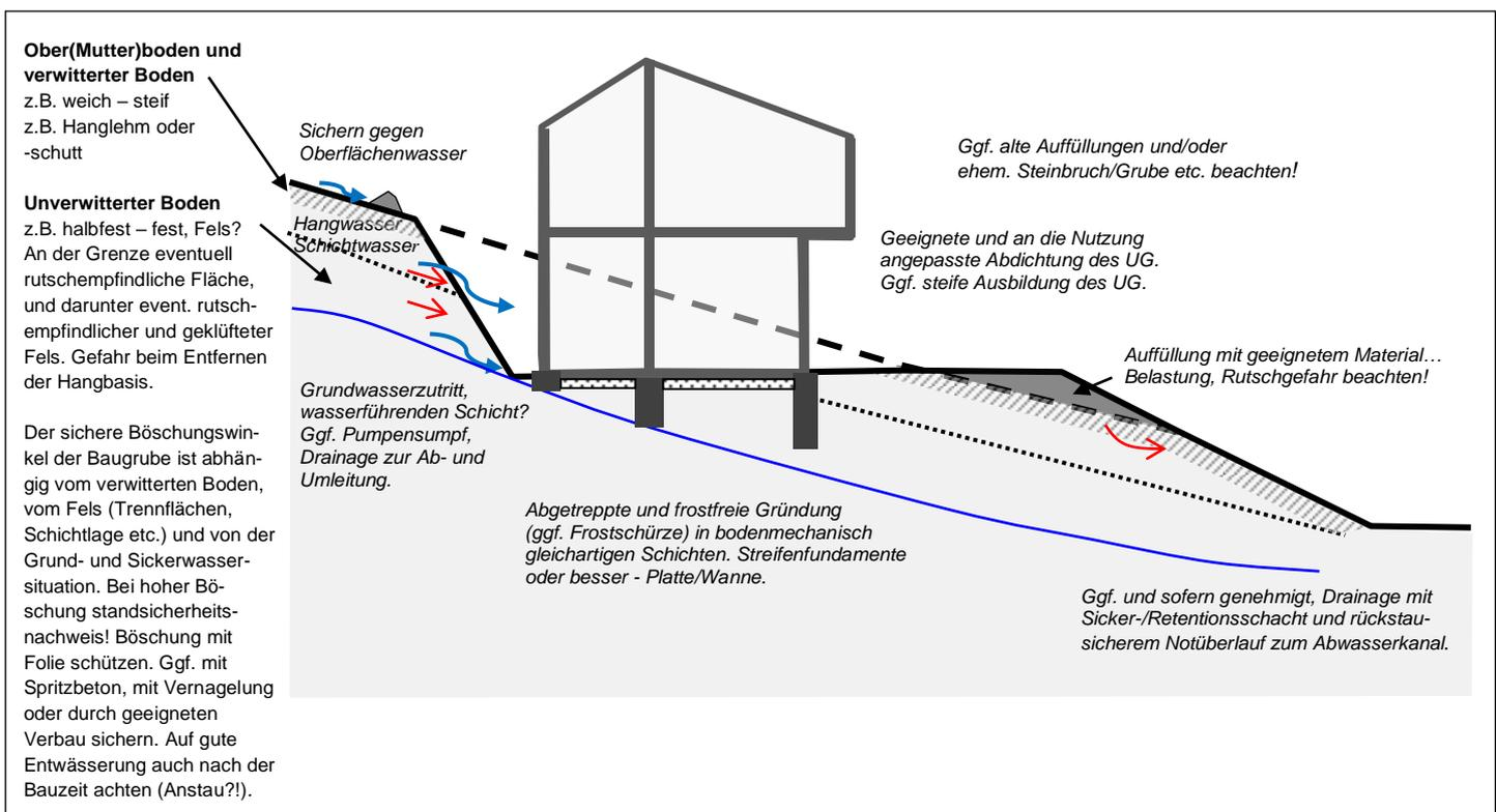
**Abb. 18: Bauen am Hang** (schematisches Beispiel)
