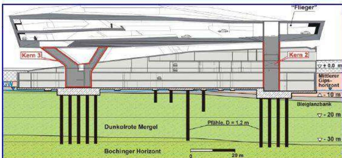
**Abb. 17a: Bohrpfahlgründung des Porsche-Museums in Stuttgart-Zuffenhausen im Gipskeuper.**
