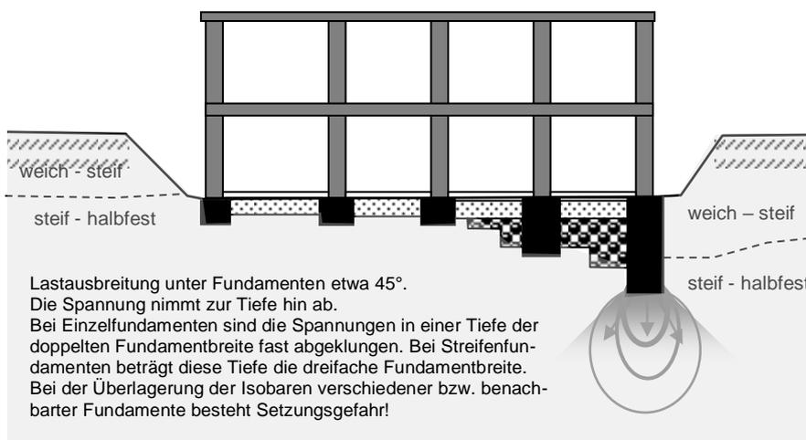
**Abb. 16: Streifen(rost)fundamente, Bodenaustausch und vertiefte Flachgründung, Pfeiler- oder Brunnengründung in bindigem Boden mit steifer Konsistenz.**
