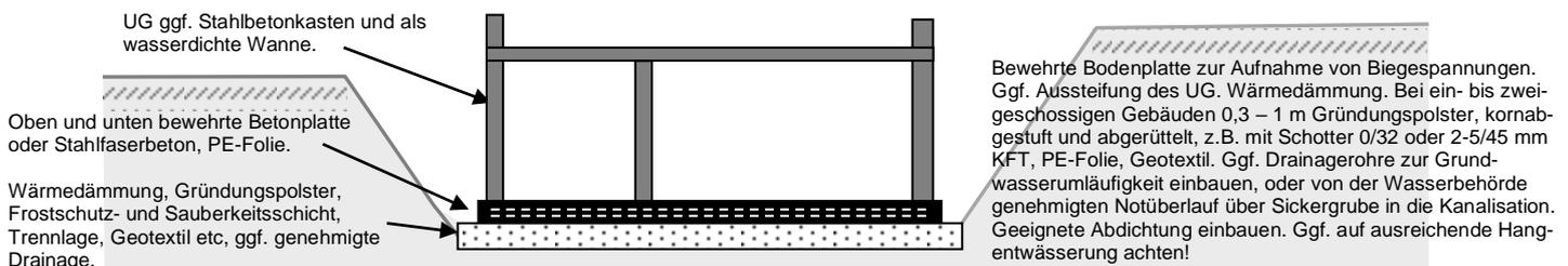
Abb. 15: Plattengründung z.B. in nichtbindigen oder sehr unterschiedlichen Böden
