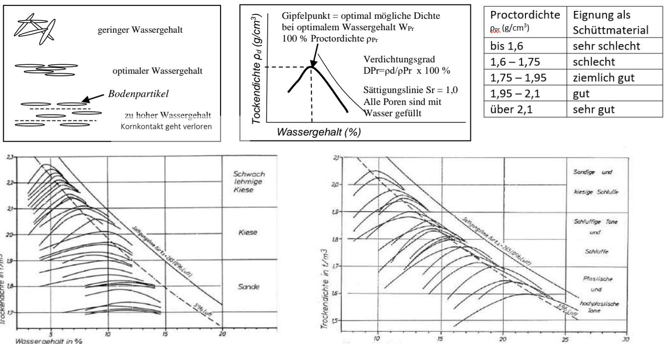
Abb. 14-3: Trockendichte und Wassergehalt, Proctorkurven von nichtbindigen und bindigen Böden. Aus W. Dachroth 2017.
