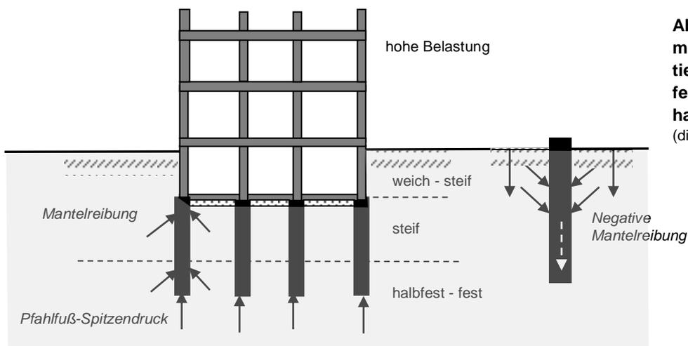
**Abb. 17: Bohrpfahlgründung mit hoher Sohlpressung auf tiefliegende Bodenschicht mit fester Bodenconsistenz oder harter Festigkeit (Fels)**
