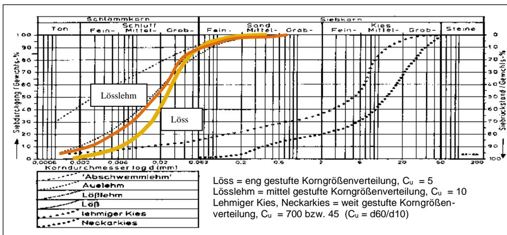
**Abb.12a: Kornverteilungskurven (Kornsummenlinien), Klassifikation nach DIN 4022.**
