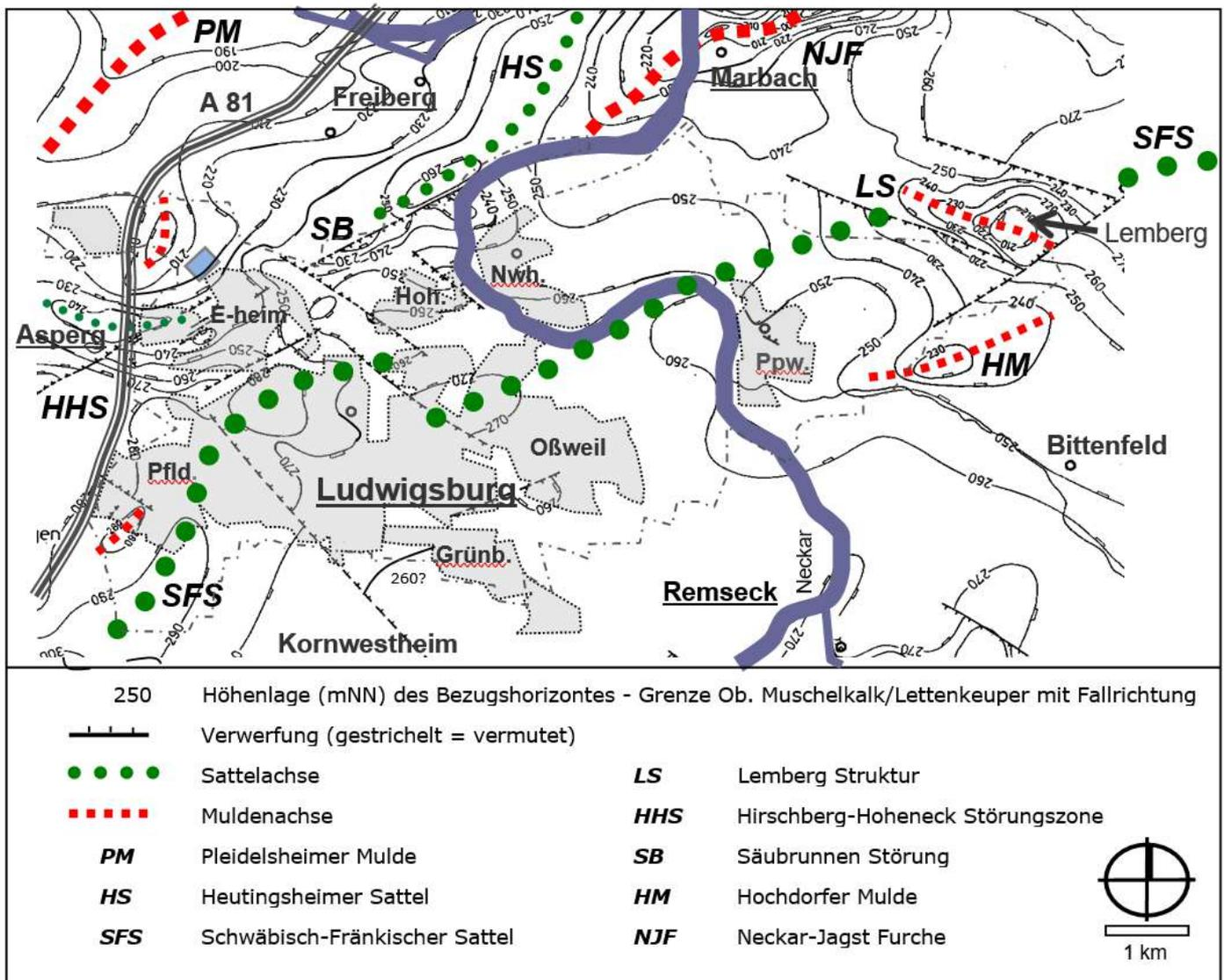
**Abb. 8: Schichtlagerung und tektonische Strukturen im Raum Ludwigsburg**
