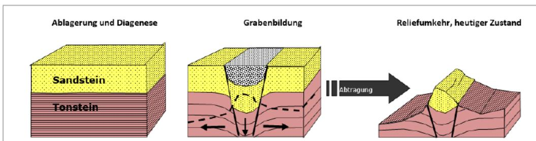
Abb. 7: Reliefumkehr durch Grabenbildung
