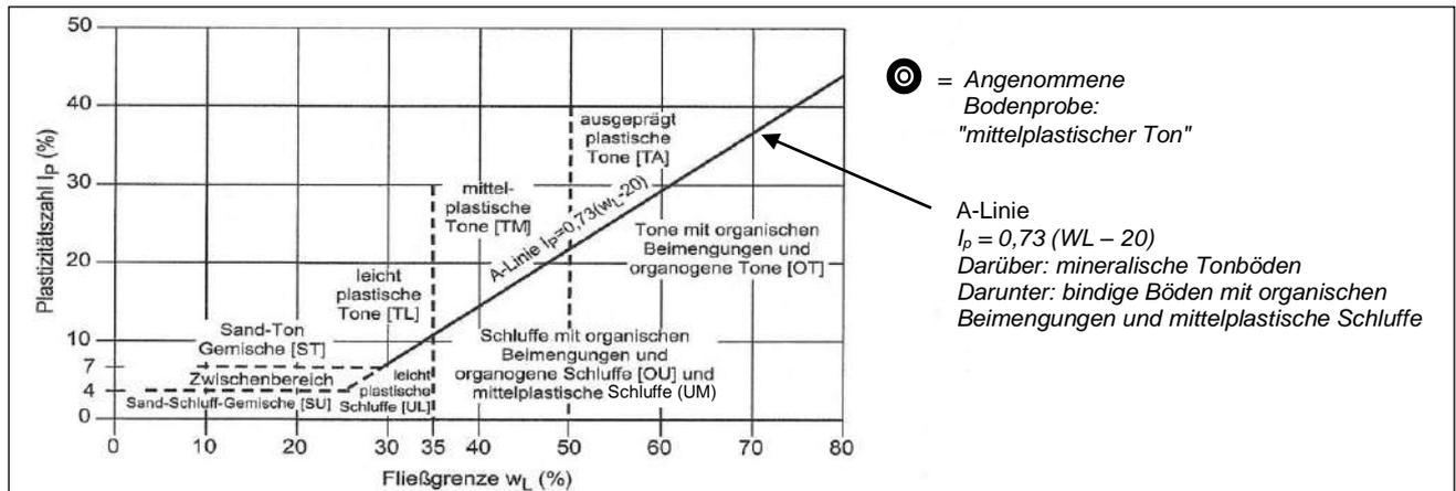
**Abb. 14-7: Plastizitätsdiagramm nach Casagrande zum Benennen von Bodenarten.**
