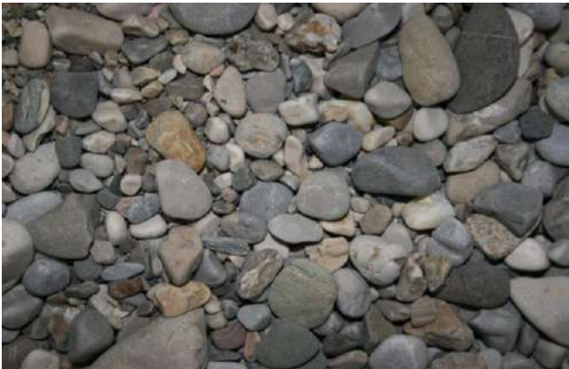
Kies und Schotter plattig, kantengerundet und gerundet. Bild: Bayerisches Landesamt für Umwelt.
