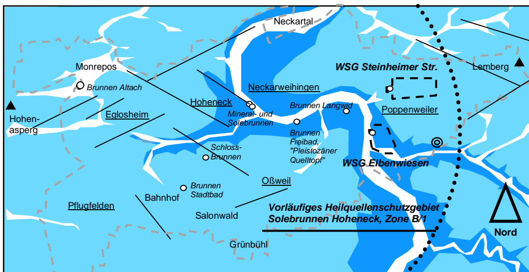
Abb. 10: Hydrogeologische Einheiten und Grundwasserschutzgebiete in Ludwigsburg. Bis auf einen kleinen Bereich am Lemberg ist die gesamte Markung von Ludwigsburg westlich der punktierten Linie seit 2009 "Vorläufiges Heilquellenschutzgebiet B/1".
