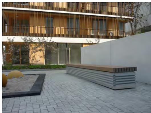
Abbildung 35: Lüftungselement mit Sitzauflage
