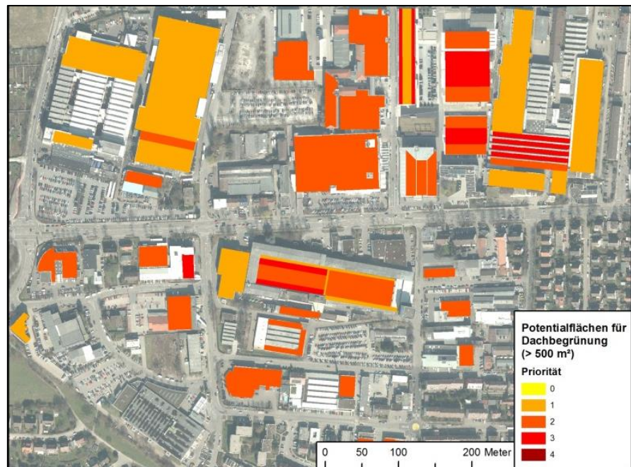
Abbildung 92 - Potenzialflächen für Dachbegrünung aus dem Forschungsprogramm „Klimawandel und modellhafte Anpassung in Baden-Württemberg“ (Quelle: Hemberger und Utz, 2014, verändert)
