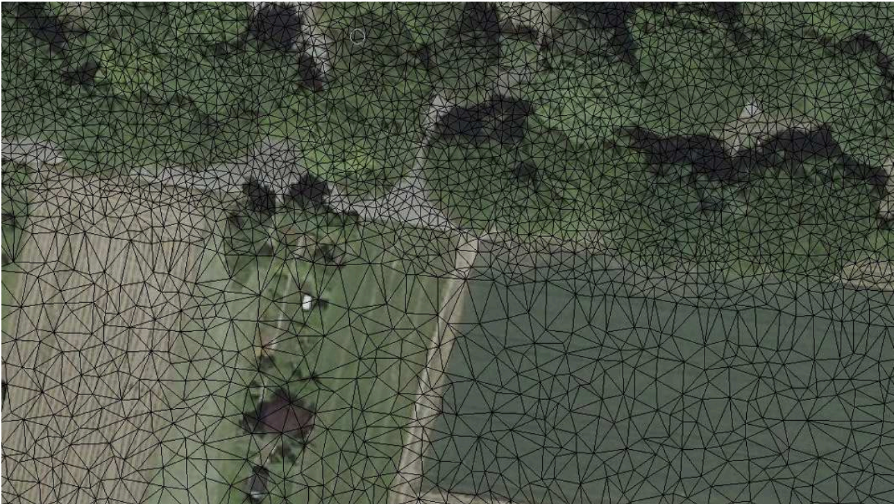
Abb. 3 Berechnungsnetz Pflugfelder (Bildquelle: Digitales Orthofoto © Landesanstalt für Geoinformation und Landesentwicklung)
